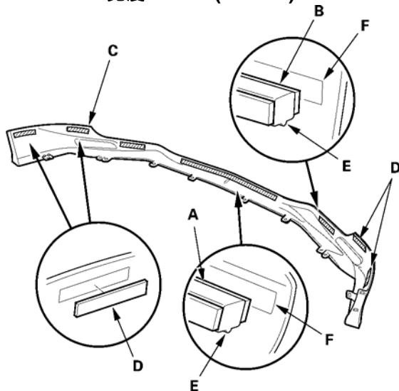
7. 如果重新安装阻流板, 则在将阻流板重新安装至保险杠之前, 从双面胶带处折叠粘接衬布边缘。
