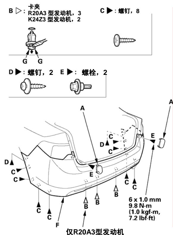
2. 推动轮罩拱部位的后保险杠(A), 并将其从侧垫片(C)的卡钩(十处)(B)上拆下。
