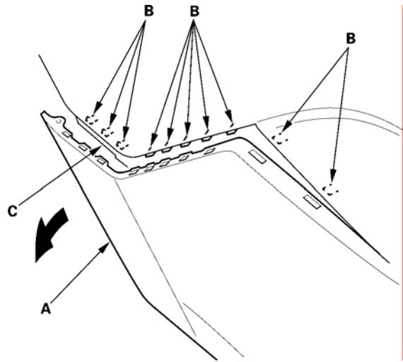
3. 在助手的帮助下, 将轮罩拱部位从侧垫片(A)上拆下的同时, 推动后保险杠, 从侧垫片(C)卡钩(B)上松开保险杠。
