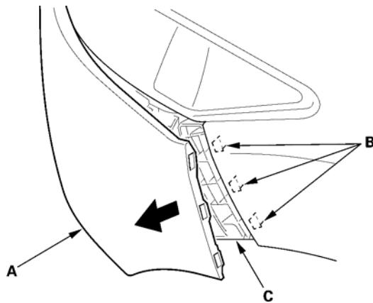
4. 在助手的帮助下，将前保险杠(A)的轮罩拱部位从侧垫片(B)上拉开的同时，推出前保险杠，从上梁(D)卡钩(C)上松开保险杠。
